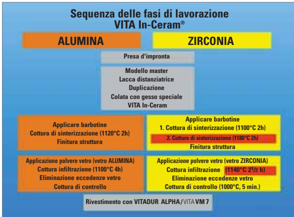
Fig. 1: Confronto della sequenza delle fasi di lavorazione di VITA In-Ceram ALUMINA e VITA In-Ceram ZIRCONIA.
