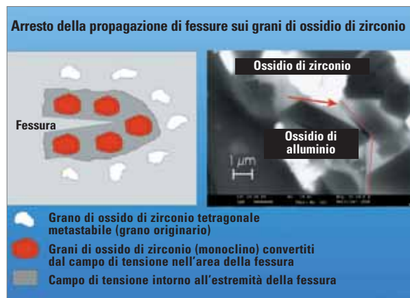
Fig. 6: Meccanismo di blocco della propagazione di fessure (a sinistra) e ripresa SEM di una fessura (di fianco alla riga rossa) che attraversa il vetro infiltrato nella struttura e viene arrestato (punta della freccia) da una particella di ossido di zirconio (bianco).
